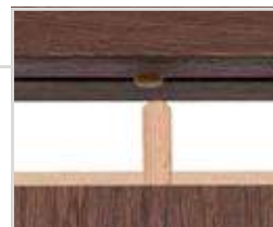
Îmbinare durabilă cu dibluri
